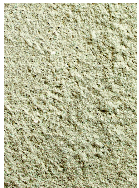
Dezente Färbung der Betonplattenoberfläche durch Kies aus Andeer-Granit.
